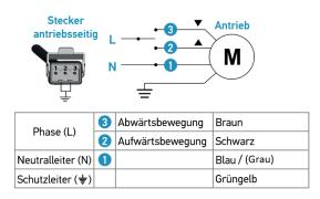
! Der Antrieb kann parallel verkabelt werden. Auf die Maximallast des Schalters oder der Steuerung ist zu beachten (Spitze des Einschaltstroms: 9A während 3 ms).
